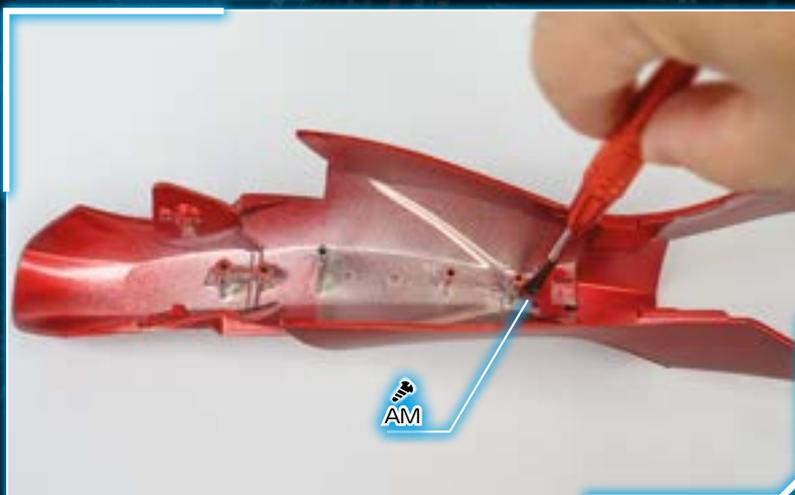
2 - Закрепите деталь (58B) одним винтом AM. Закручивайте винт очень аккуратно, чтобы не сорвать резьбу.
